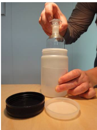
Bilde 5: Glassflaske (CO 2 -prøve) inn i plastbeholder som er fylt med vann
